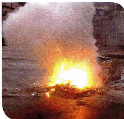
Reacción de un fuego de magnesio al arrojarle agua
