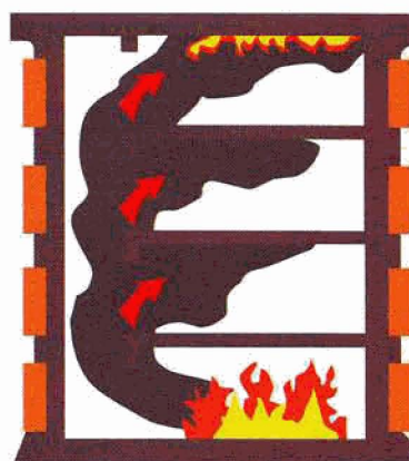
Transmisión de calor por convección
