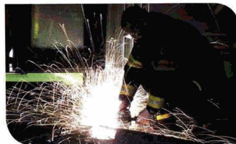
Una chispa puede tener suficiente energía para inflamar un mezcla de gases
